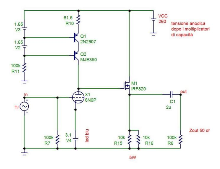
Come si vede la modifica è semplicissima: dall'anodo della 6N6P si entra nel gate del MosFet eliminando il condensatore d'uscita che sarà poi utilizzato sul source del MosFet.
