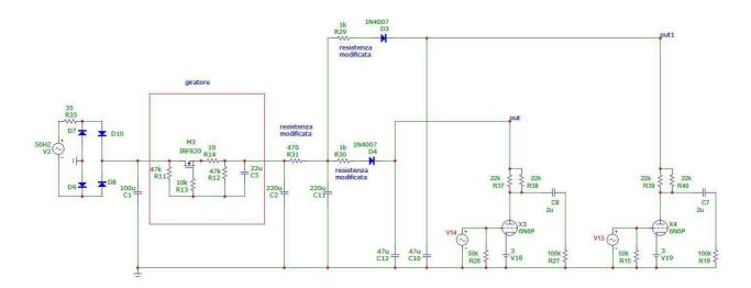
La "vecchia" resistenza da 470 ohm/5W è ora utilizzata nella seconda cella di filtraggio al posto della precedente da R31 da 1 Kohm.
