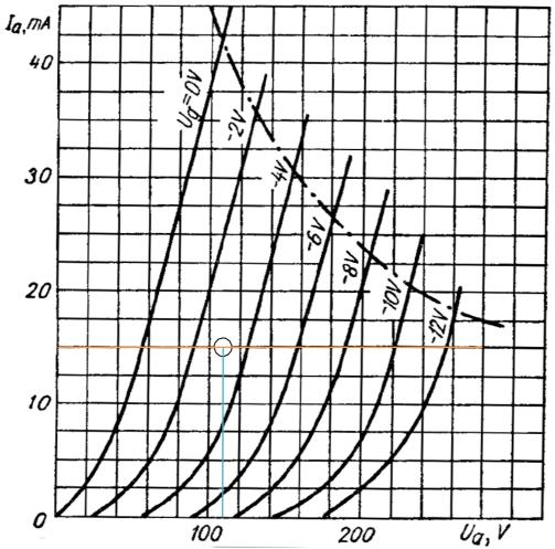
Il vantaggio è quello di una maggiore linearità del sistema e quindi di una ulteriore diminuzione della distorsione e questo si può dedurre osservando la praticamente perfetta equivalenza della spaziatura fra le curve intersecate dalla retta di carico nel range Vg=0 e Vg=-6V.
