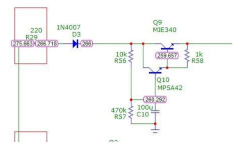
L'unica particolarità sta nella rete di polarizzazione della base del Darlington che è realizzata con un partitore (R56-R57) invece che con una singola resistenza e dalla presenza di R58 in uscita.
