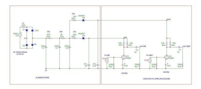
Poco altro da dire se non che i condensatori dell'alimentatore sono tutti elettrolitici con tensione di lavoro di 350V min., che le R34 ed R31 è bene che siano da 5W di dissipazione mentre per R29 ed R30 bastano componenti da 1W.
