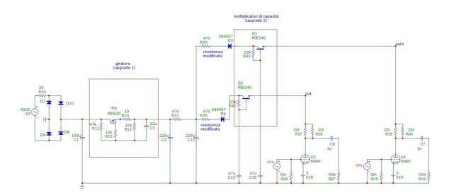
Notate che sono cambiati ancora i valori di R29 ed R30, ora entrambe da 470 ohm per il solito aggiustaggio della tensione finale di alimentazione che sarebbe diminuita a causa della caduta di tensione indotta dai moltiplicatori.
