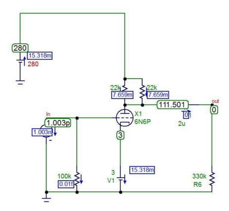
Per 2V RMS out la distorsione, di sola seconda armonica, si mantiene poco al di sotto dello 0.12%, risultato piuttosto buono considerando la semplicità del circuito.
