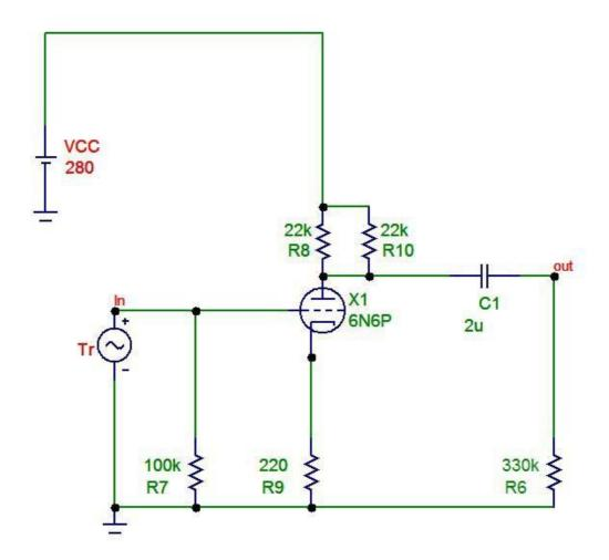
Gli 11 Kohm della resistenza di placca sono realizzati da un parallelo di due 22K/2W perché la dissipazione di ciascuna è di circa 1.25W.
